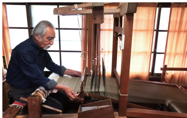
桑の葉から染めた糸が1200本セットされている手織り機
